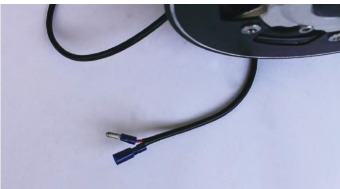
Aansluitingspunten voor de batterij.
